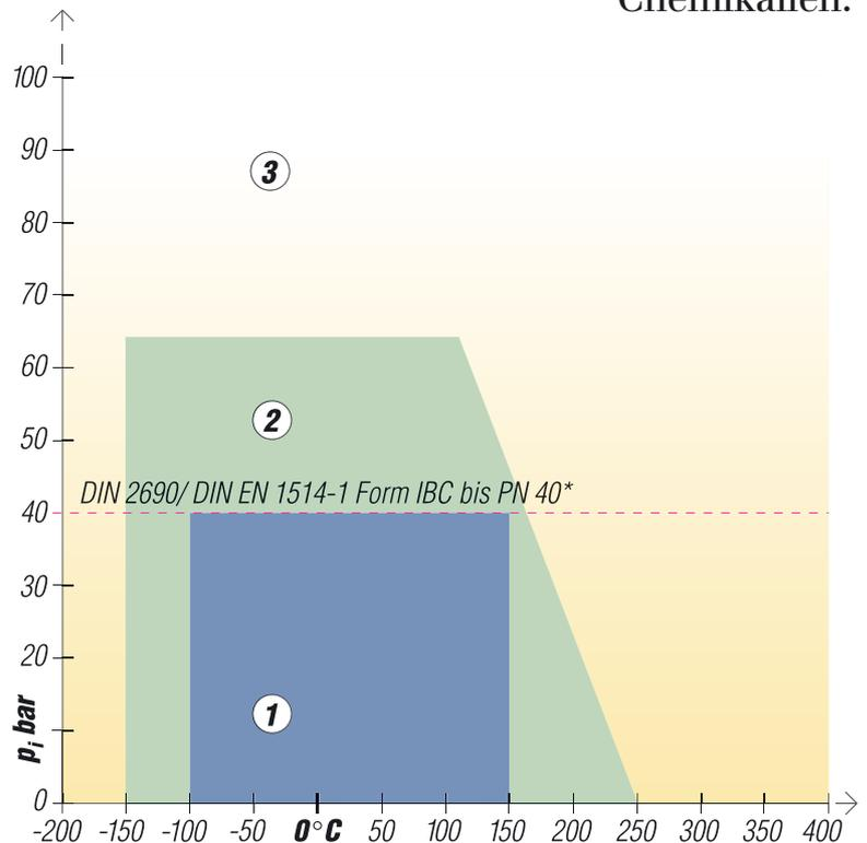
\*Flachdichtungen nach DIN 2690 sind nur bis PN 40 und für Dichtungsdicke 2 mm genormt.
