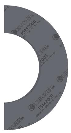
Kleberfreies Dichtungsmaterial aus expandiertem Graphit mit einer perforierten 0,1 mm dicken Spiessblecheinlage aus Edelstahl 1.4401.
