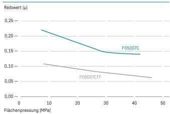
↑ Vergleich der Reibwerte von Stopfbuchspackungen aus F05007C (ohne PTFE) bzw. F05007CTF als Funktion der Flächenpressung.
